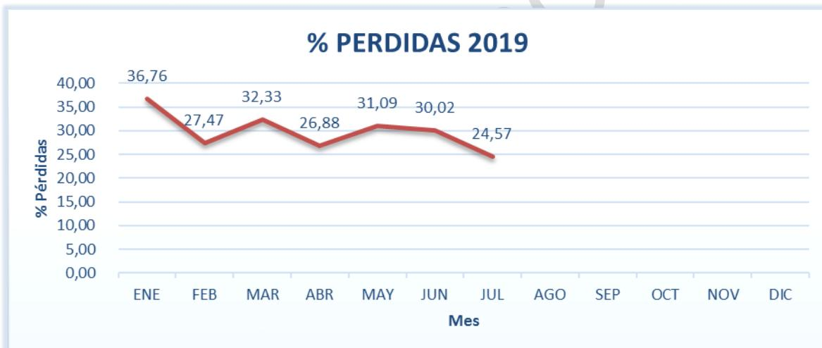
La grafica muestra la disminución significativa en el porcentaje de pérdidas a lo largo de lo transcurrido del año, esto se logró con el cambio de las válvulas y compuertas de la PTAP la Colina, objeto del contrato de optimización y ampliación de la Capacidad de tratamiento. El porcentaje de pérdidas disminuyo en más del 12%.
