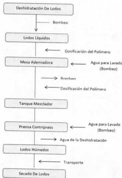
**Figura 3.** Diagrama de flujo de deshidratación de lodos
